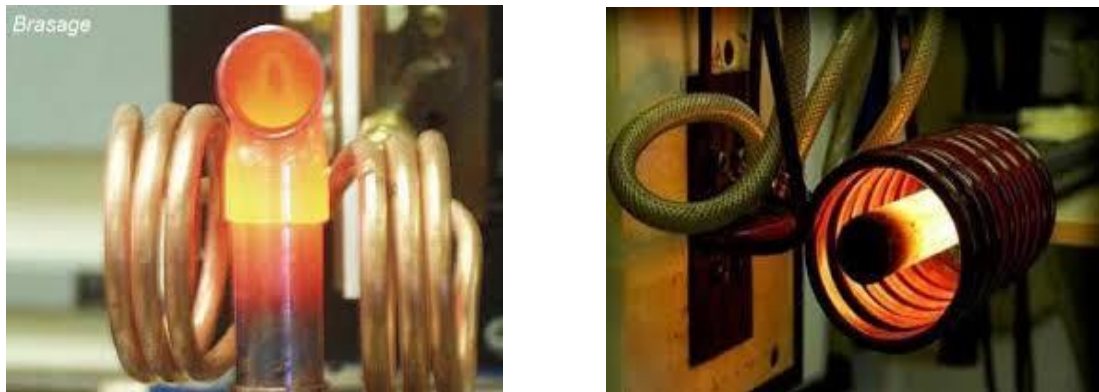
Figure I.10 : Des inducteurs dans la fusion par induction
