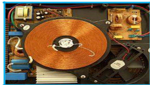
Figure I. 2 : Vue intérieure de l'électronique d'une plaque à induction.
