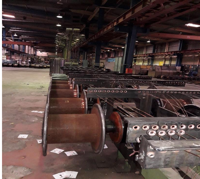
Figure III.8 ensemble d'implantation de dérouleur (A) et vue réel (B)
