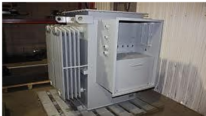
Figure I.12 Cuve d'un transformateur.
