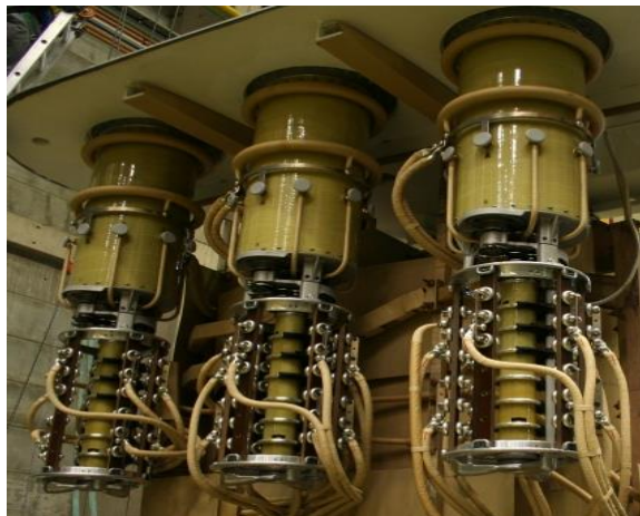
Figure II.3 : Changeur de prises (un pour chaque phase). [13]
