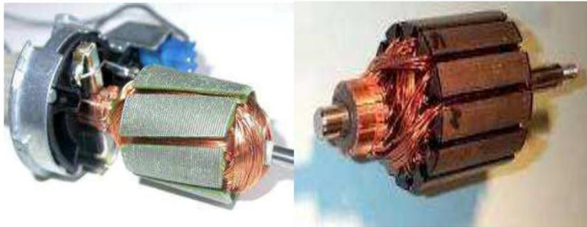
Figure I.3 : Construction d'un rotor bobiné.
