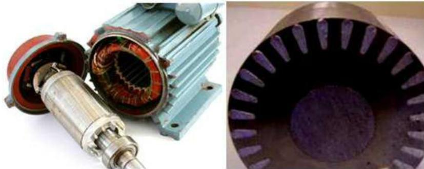
Figure I.4 : Machine asynchrone à cage d'écureuil.
