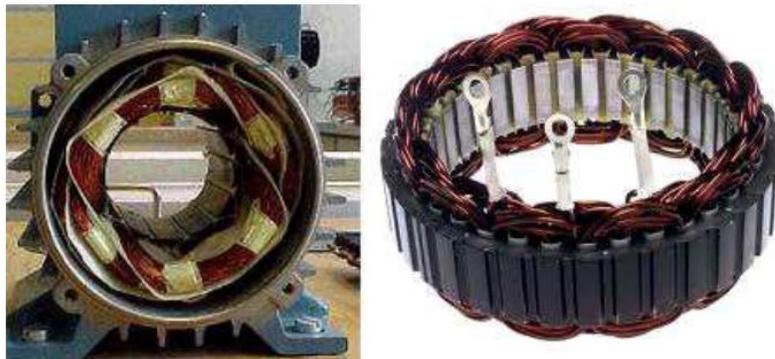
**Figure I.2 : Stator de la machine asynchrone**
