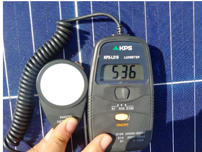
Figure IV-9: Mesure de l'éclairement avec le Luxmètre.
