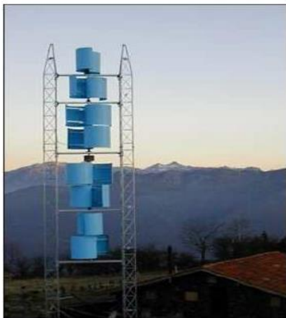
La figure (I.3) : Aérogénérateur à axe vertical (structure de Savonius). [5]
