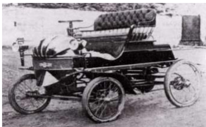
Figure 1 : Automobile Pieper en 1900 avec une propulsion essence-électrique
