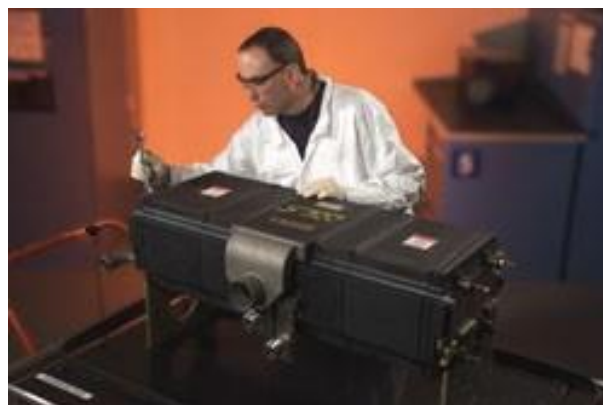
Figure 23 : Pile à combustible 75 kW UTC pour des voitures et des autobus
