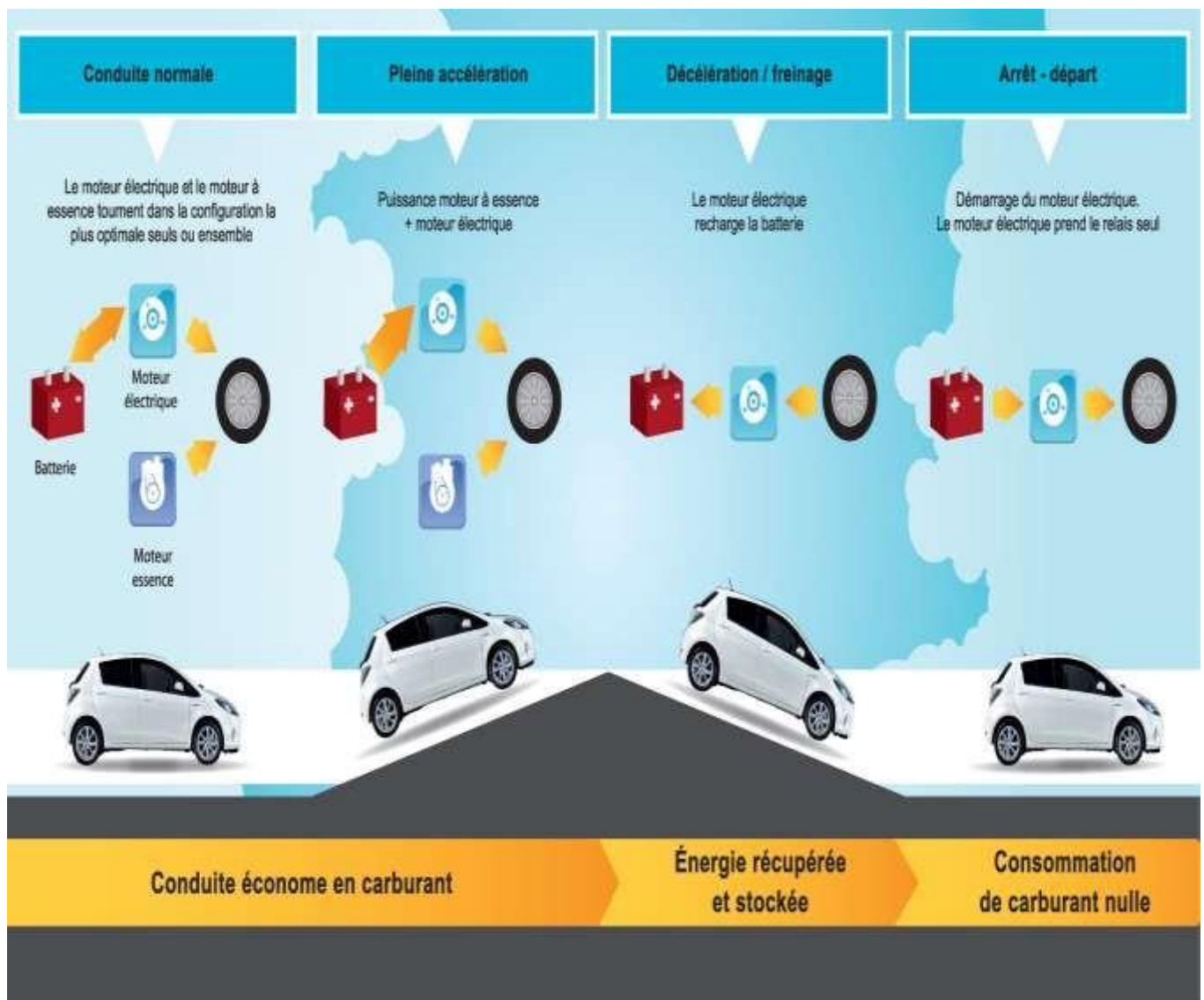
La figure 7 : présente le fonctionnement dynamique du VEH.
