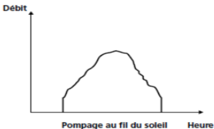
Figure (I.3) : Caractéristique de débit pour le pompage au fil de soleil
