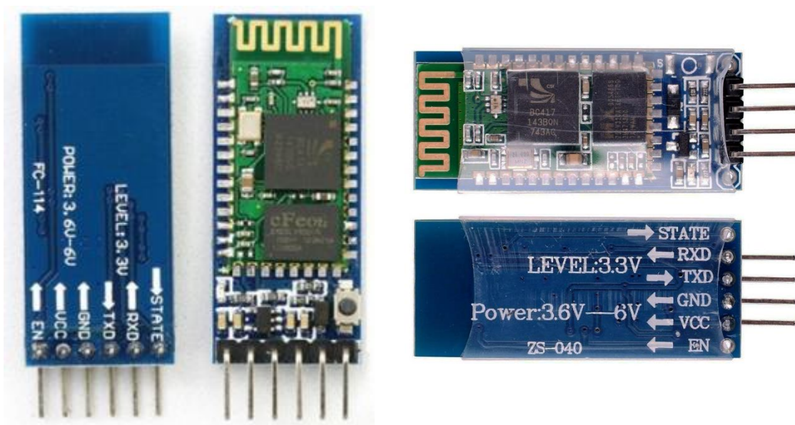
FIGURE 21 MODULES BLUETOOTH POUR L'ARDUINO. HP 05 / HP 06
