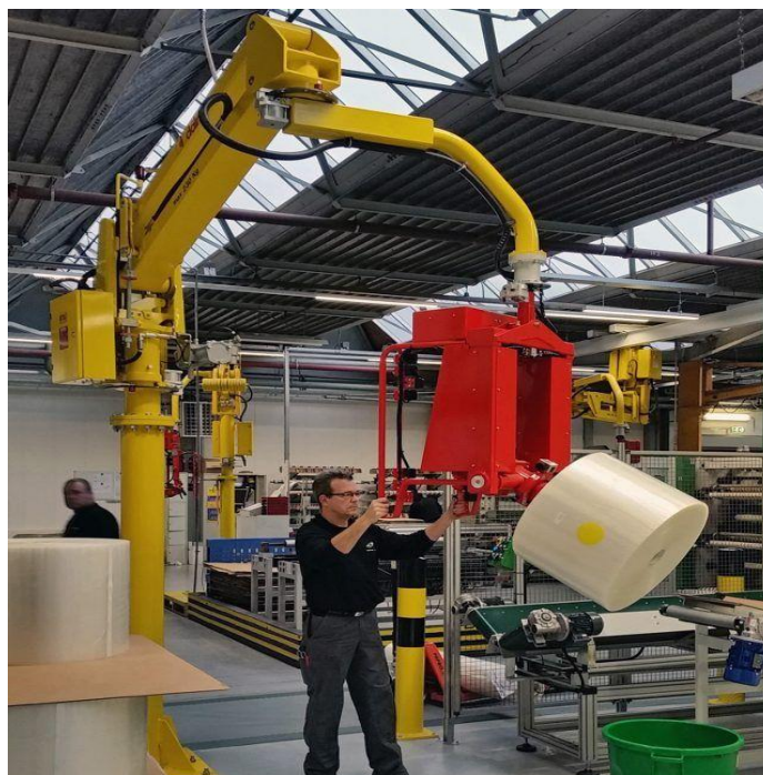
FIGURE 7 MANIPULATIONS DE BOBINES DE PAPIER OU DE FILM PLASTIQUE
