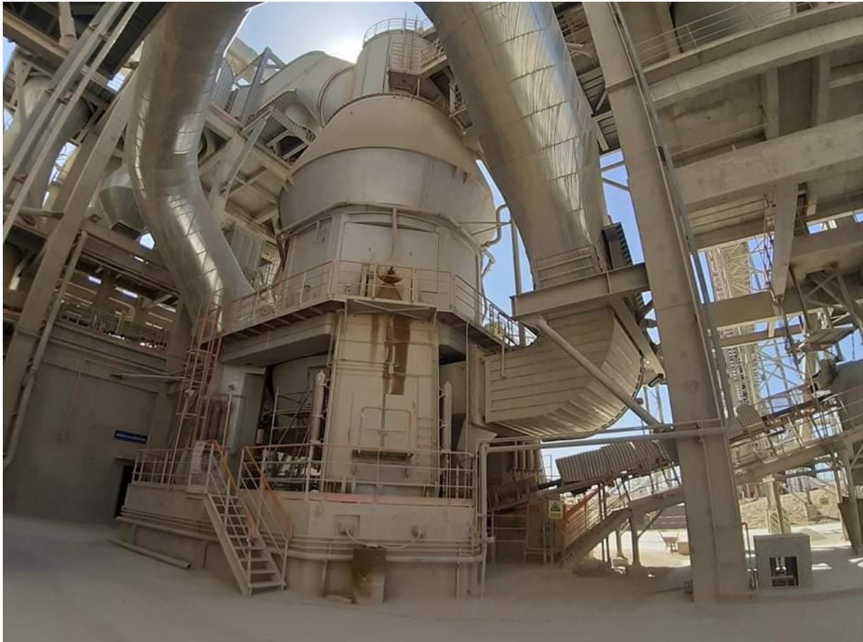
**Figure II.3 : Broyeur Cru**
