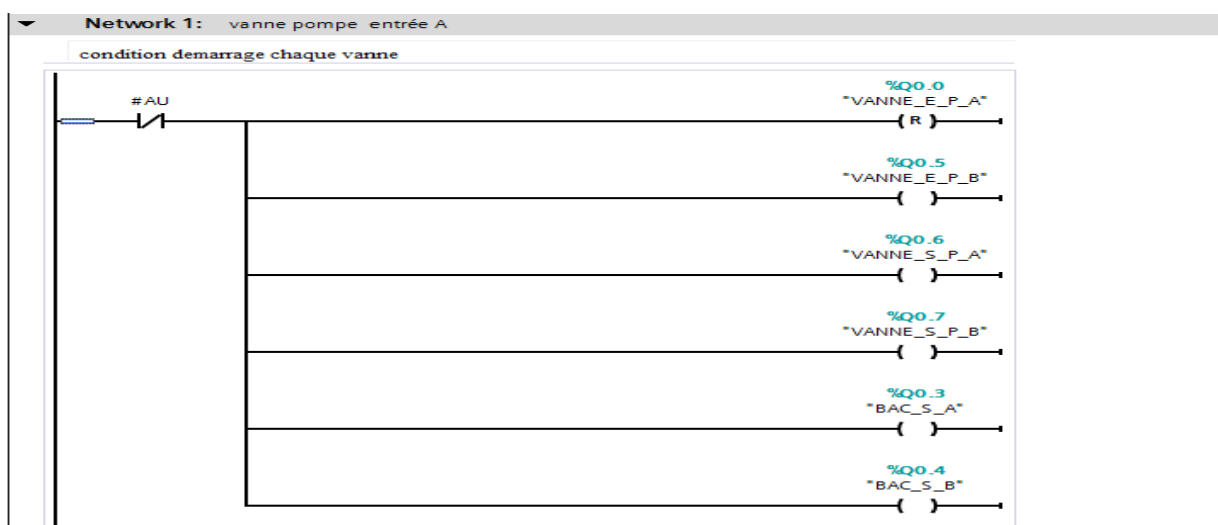
Figure IV.26 : condition démarrage la vanne
