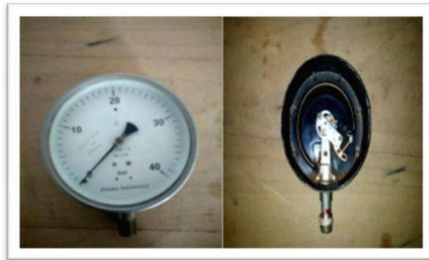
Figure I.17: Manomètre et son tube Bourdon
