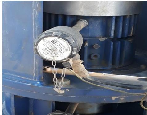
*Figure I. 17 : Le Transmetteur de Température Pt100*
