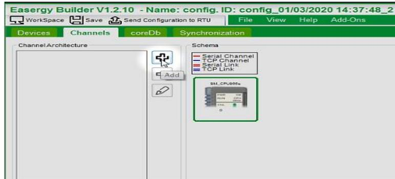
Figure IV. 24 : Configuration des canaux de communication
