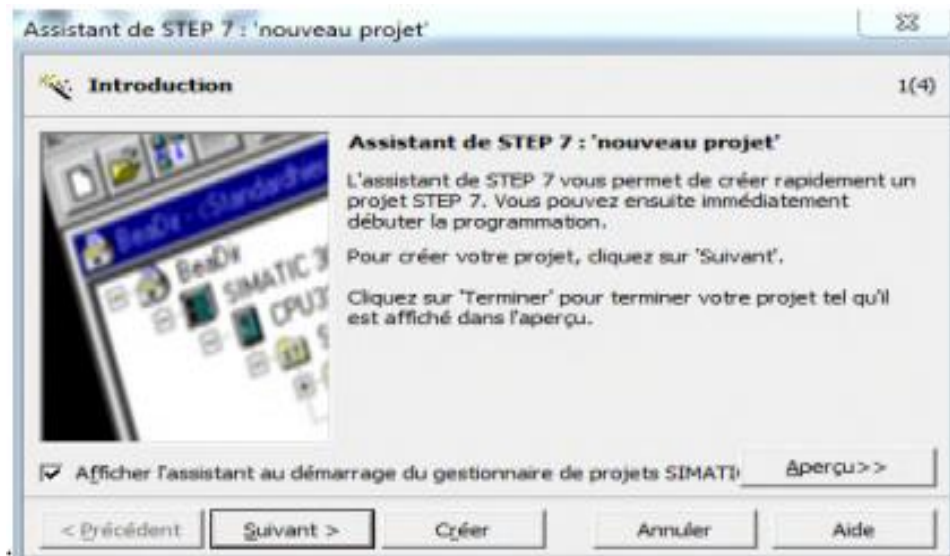
Figure II. 13: Création du projet avec SIMATIC Manager
