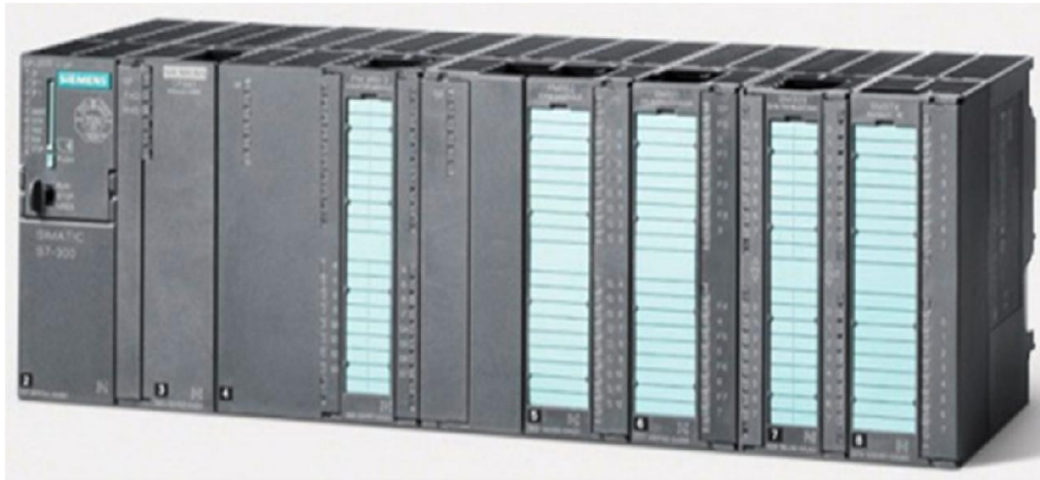
Figure II. 2: Automate modulaire (Siemens). [11]
