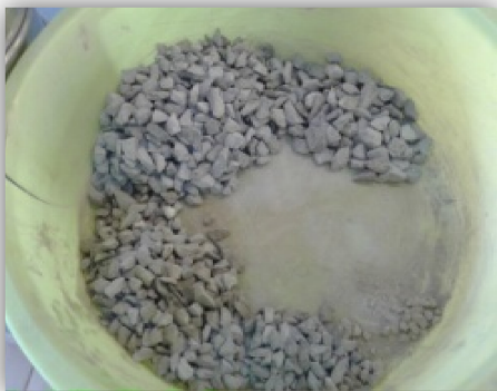
Figure 59 : classes granulaires d'un gravier 8/16 et 3/8
