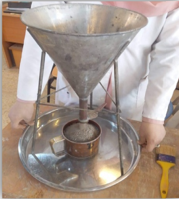
Figure 60: Essai de la masse volumique apparente de sable
