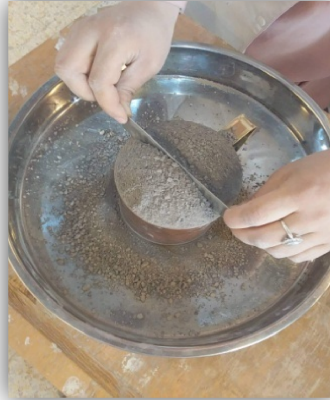
Figure 60: Essai de la masse volumique apparente de sable
