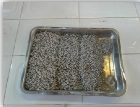
Figure 59 : classes granulaires d'un gravier 8/16 et 3/8
