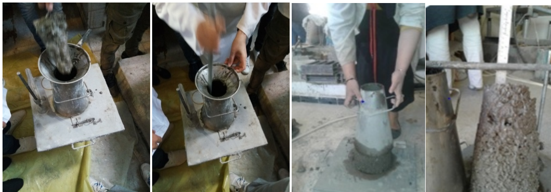
Figure 68: Mode opératoire de l'essai d'Affaissement au cône d'Abrams
