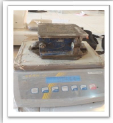
figure 47: peser du moule rempli de béton frais
