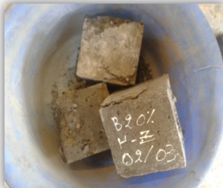
Figure 72 : Une éprouvette BP 10% après l'écrasement à la presse
