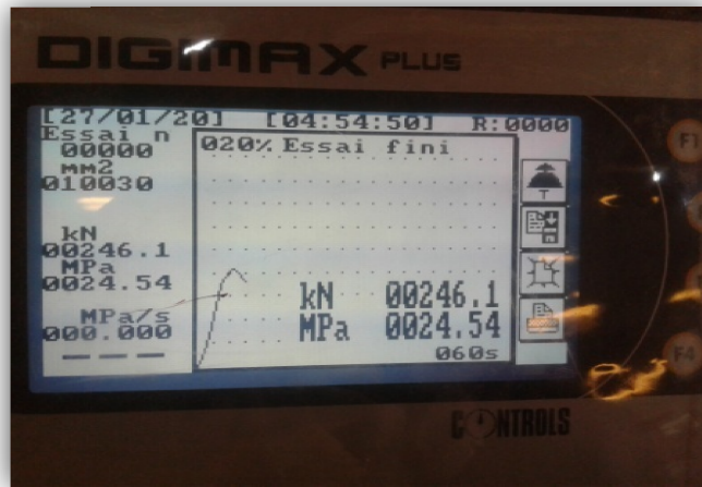
Figure 71: la résistance a la compression en fonction du temps pour la BP 10% à appareil de compression
