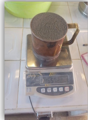
Figure 60: Essai de la masse volumique apparente de sable
