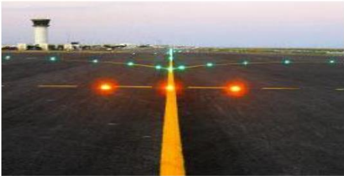
Figure 8.6. Balisage d'extrémité de piste
