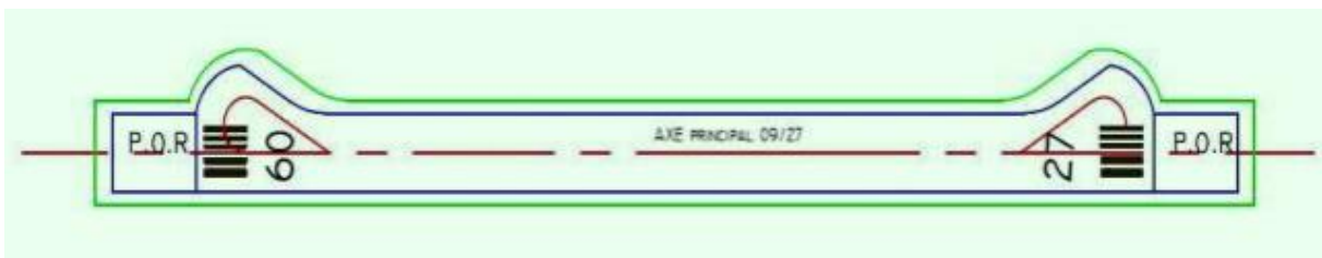
Figure 8.1. Marquage d'identification sur une piste.
