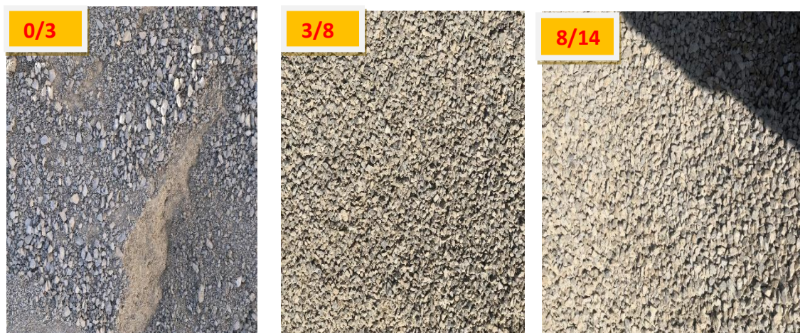
Photo .VII. 17 : les différents types de gravier pour le « BB »
