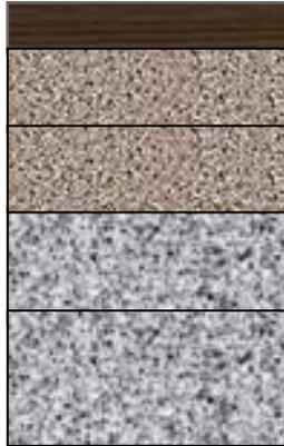
Avec une couche d'accrochage entre la couche de roulement en **BB** et la couche de base en **GB**, et une couche d'imprégnation entre la couche de fondation en **GB** et la couche de forme en **GNT**.
