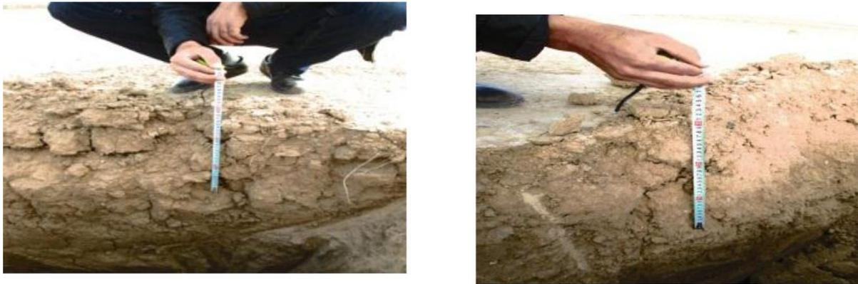
**Figure N°12 : Epaisseur de décapage.**
