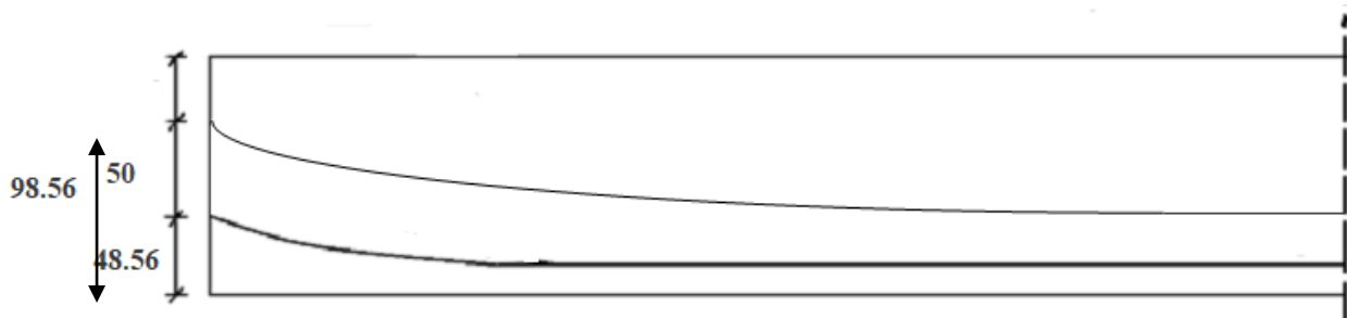
Fig. VIII.10 Tracé des câbles
