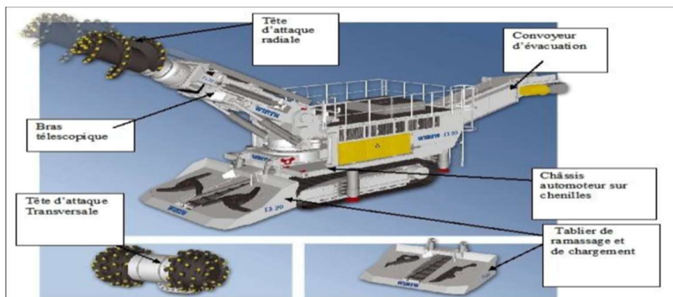
Figure II.2 : Machine à attaque ponctuelle.
