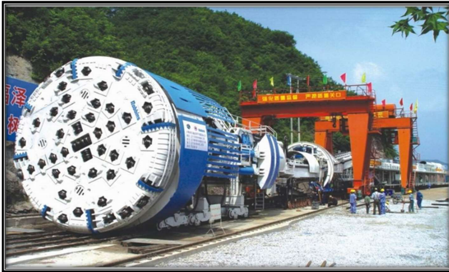
Figure II.4 : Machines à attaque global (TBM).
