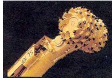
Figure II.3.b : Bras à attaque radiale.
