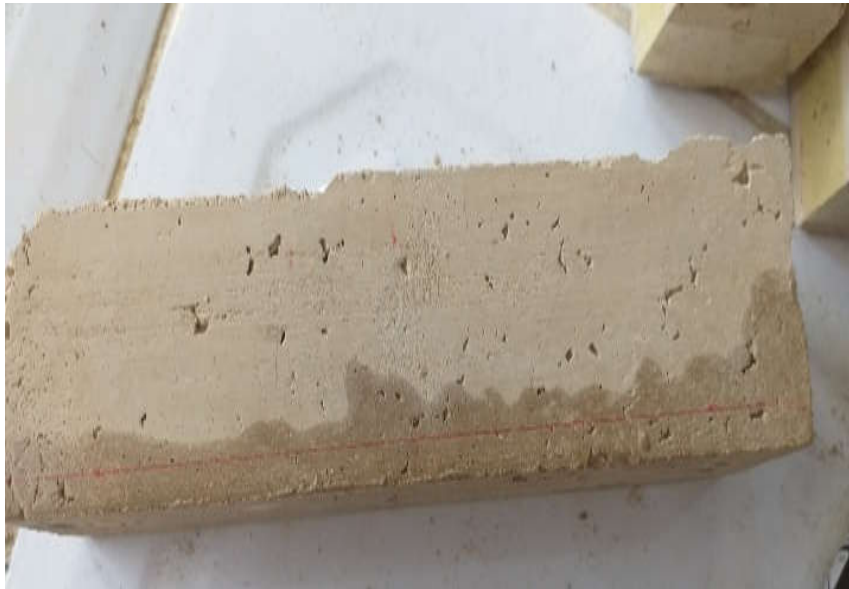
Figure 2.20: Essai d'absorption par capillaire
