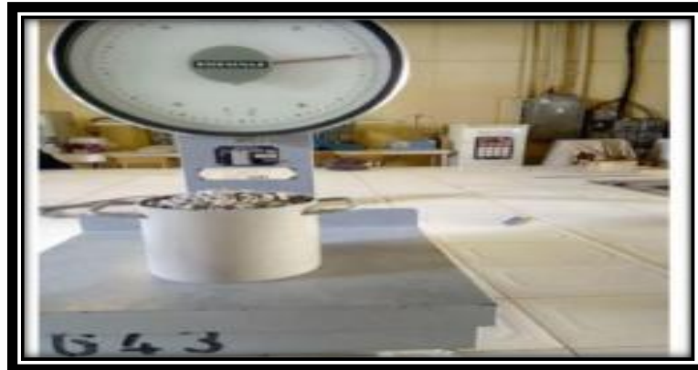
Figure .36: Procédé utilisé pour la mesure de la masse volumique apparente des graviers.
