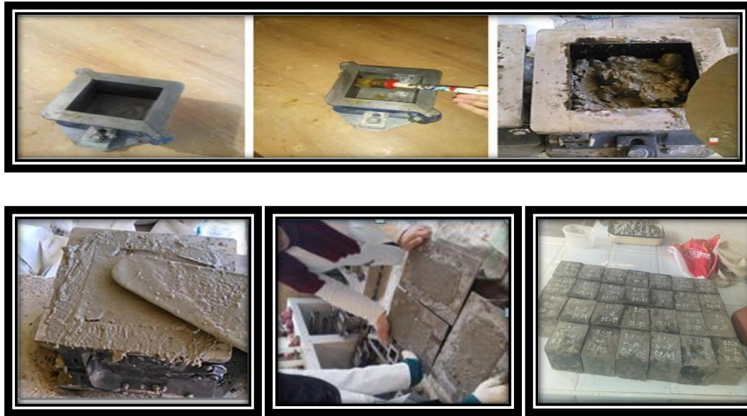
Figure .57 : Etapes de formulation des bétons et conservation des éprouvettes de bétons.
