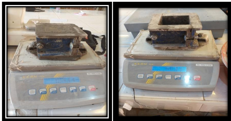
Figure 61: Mesure de la densité des bétons à l'état frais.
