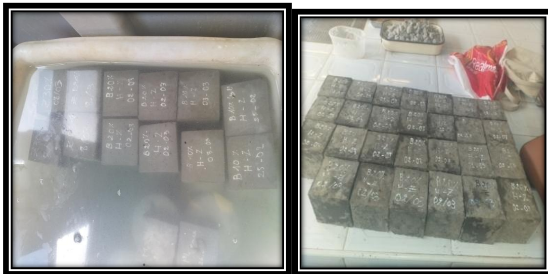
Figure .58: Mise en place du béton et conservation des échantillons dans le réservoir d'eau
