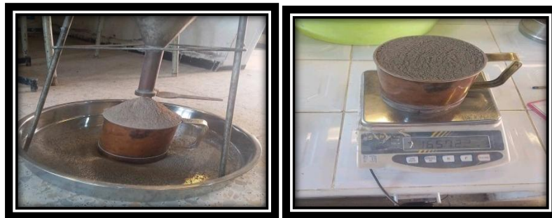
Figure .42: Mesure de la masse volumique apparente du sable concassé.
