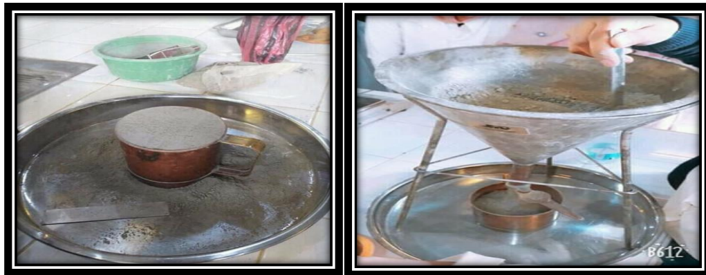
Figure.34: Procédé utilisé pour la mesure de la masse volumique apparente du liant.
