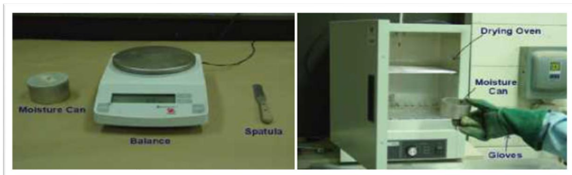
Figure II. 10 Appareillages pour mesure le Poids volumique et Teneur en eau naturelle.
