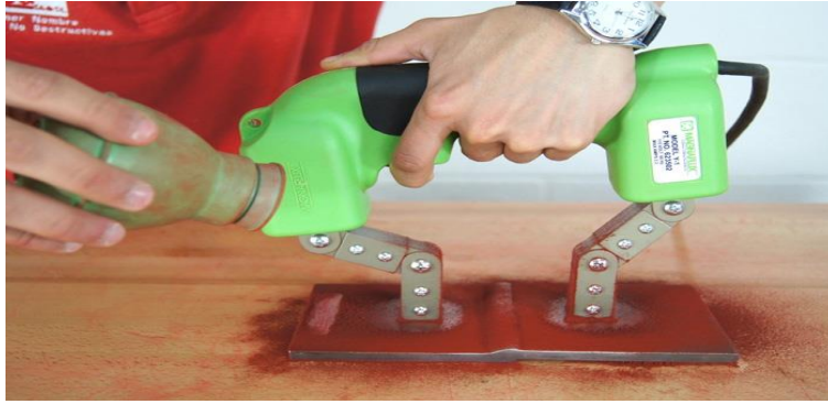
Figure.IV.3 : Image présentant l'opération de pulvérisation de la poudre magnétique avec l'utilisation d'un appareil de production d'un champ magnétique (Réf.[R37])
