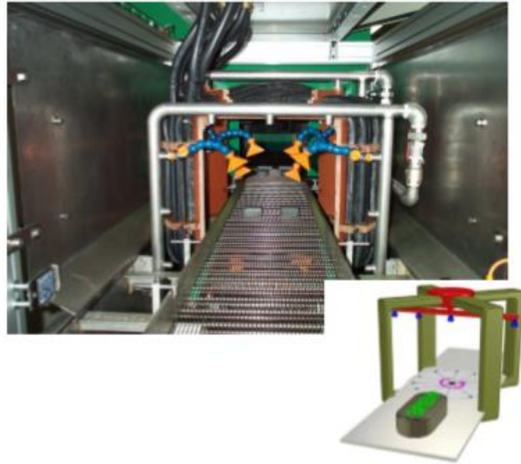
Figure. IV.11: Magnétoscopie par champ tournant chambre (Réf.[R42])
