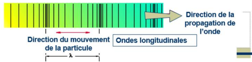
Figure VI.13 : propagation d'une onde longitudinale (Réf.[R22])
