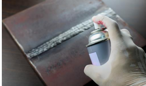
Figure .III.4 : Application du révélateur (Réf. [R34])
