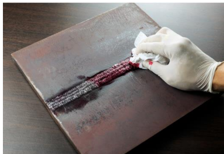
Figure .III.3: Elimination de l'excès de pénétrant (Réf.[R34])
