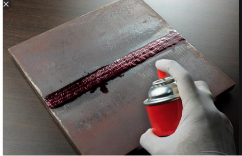
Figure.III.2 : Application du pénétrant (Réf.[R34])
