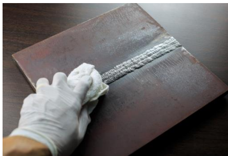
Figure .IV.2: Image présentant l'opération de nettoyage de la pièce (Réf.[R34])
