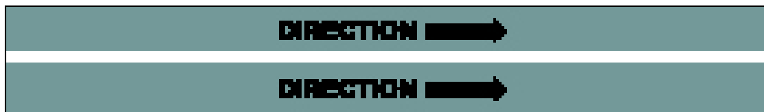
Lignes blanches continues.
