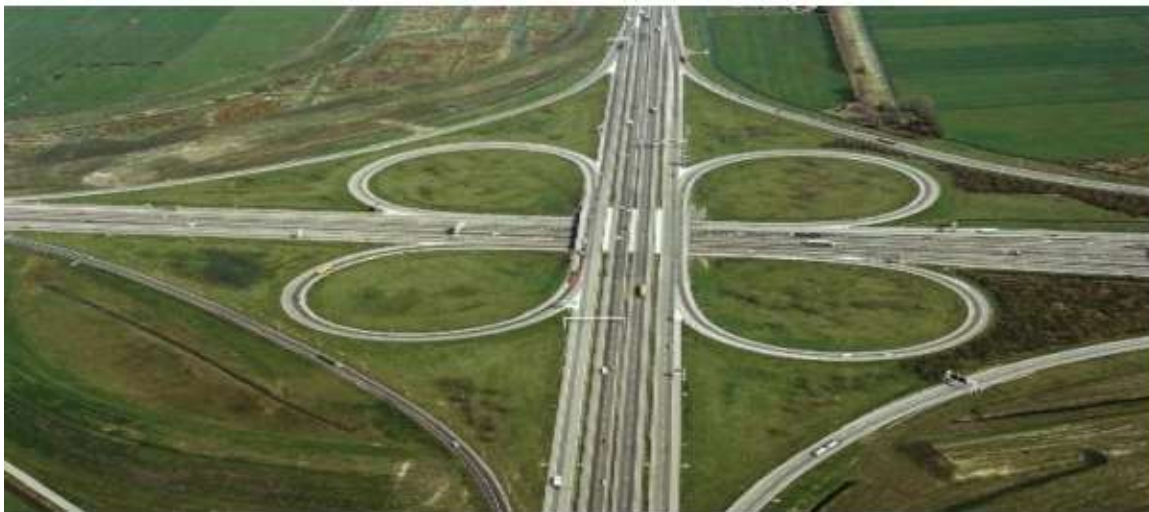
Figure VII.1: Echangeur autoroutier en trèfle complet.
