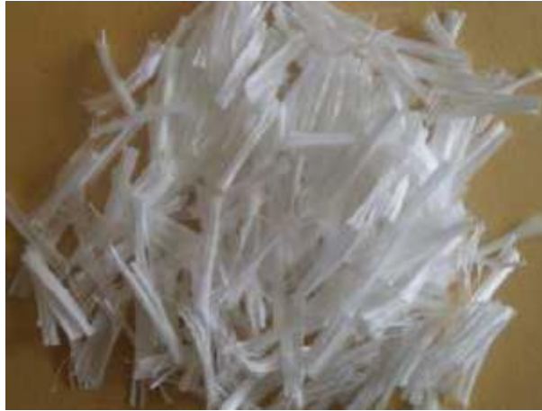
Figure 2. 9 Les fibres de polypropylène
