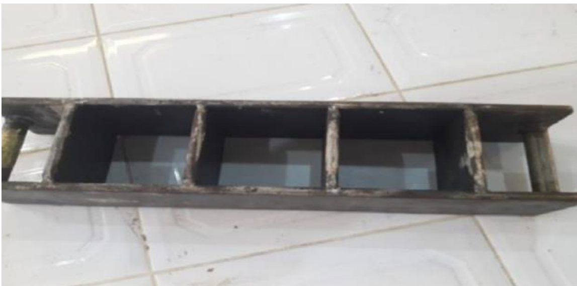
Figure 2. 10 Moule utilisé pour la fabrication des éprouvettes prismatiques (10x10x10) cm 3
