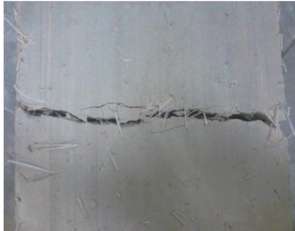
Figure I. 21: les fibres de polypropylène formant des ponts sur une fissure apparue pendant l'essai de flexion à trois points (Donkor, 2015)
