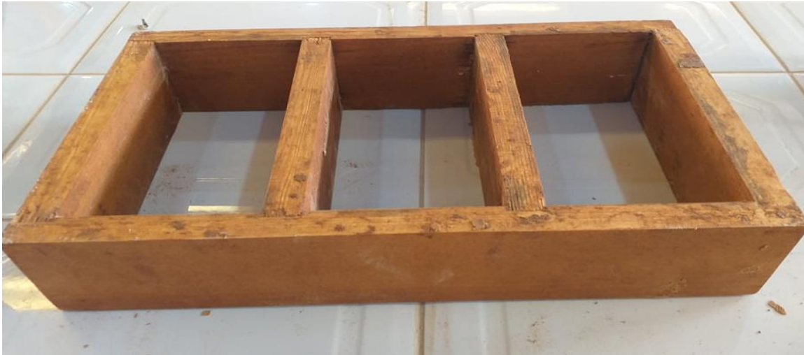
Figure 2. 11 Moule utilisé pour la fabrication des éprouvettes prismatiques (5x10x20) cm 3
