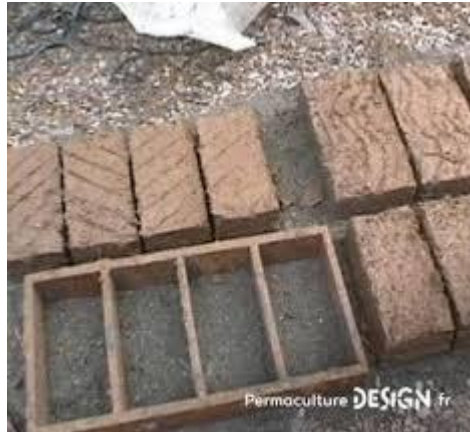
Figure I. 4: moule de l'adobe ( https://www.permaculturedesign.fr/permaculture-construction-naturelle-la-terre-crue )
