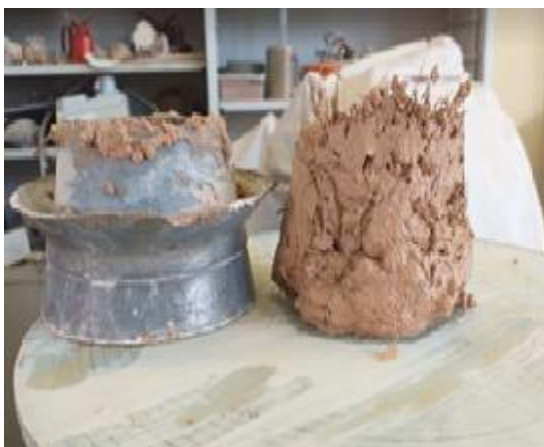
Figure III. 11: Table à secousses et la mesure d'étalement.
