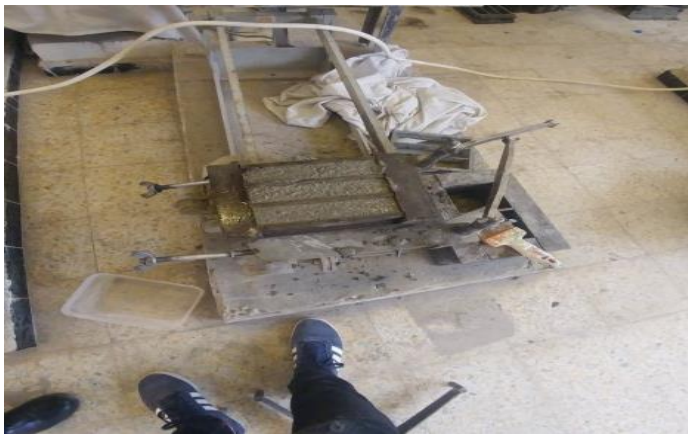
Figure 4. 4 : moule métallique (4*4*16) fixés à la table de choc
