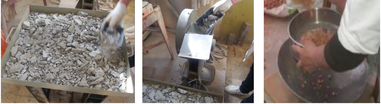
Figure 4. 2 Elaboration des sables recyclés : a. Concassage primaire des granulats recyclés, b. Broyage via le broyeur à mâchoire, c. Criblage
