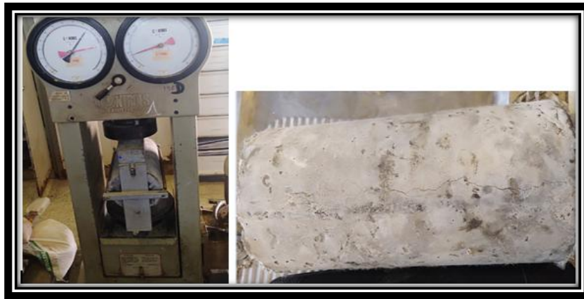
Figure III. 10: essai de traction par fendage (essai brésilien).
