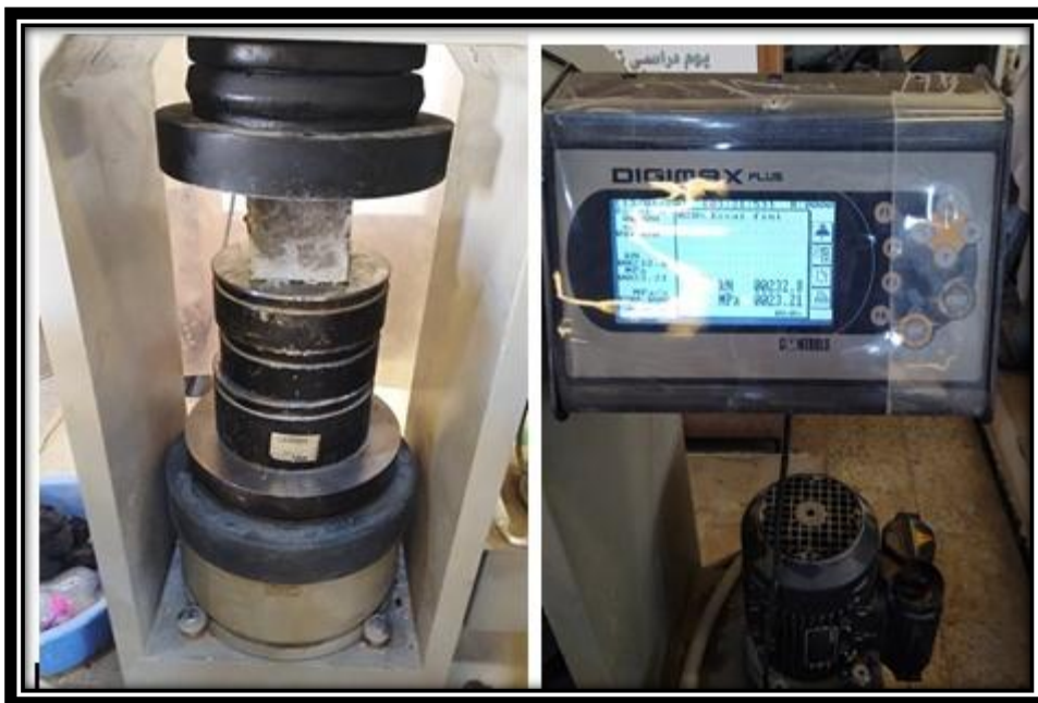
Figure II. 8: La machine pour essai de compression et affichage de la résistance.
