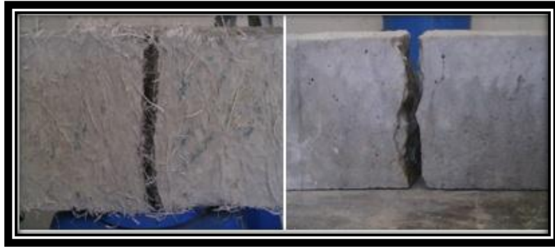
Figure III. 8: l'écrasements d'échantillons prismatique (7×7×28) du BO et BF (pp) à la résistance de traction par flexion
