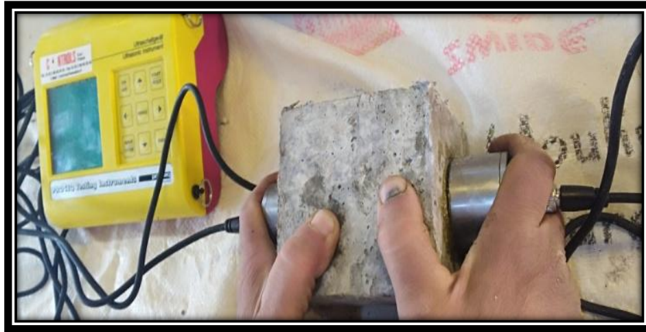
Figure III. 14: mesures à l’ultrason d’éprouvettes cubiques (10×10×10).
