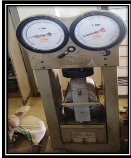
Figure II. 10: Dispositif pour mesurer la résistance à la traction fendage
