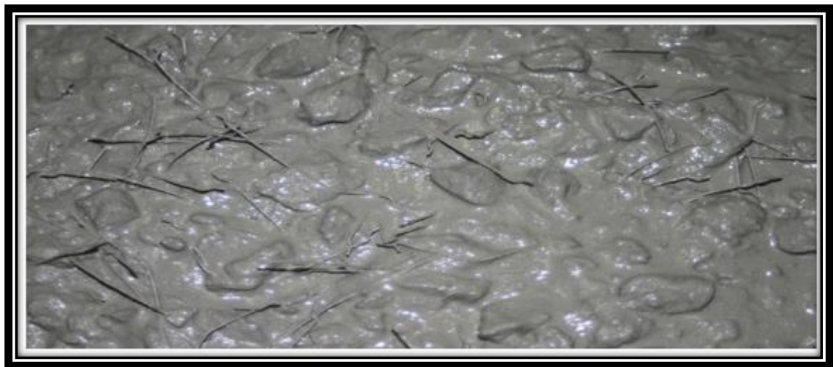
Figure I. 4: texture d'un béton fibré. [3].
