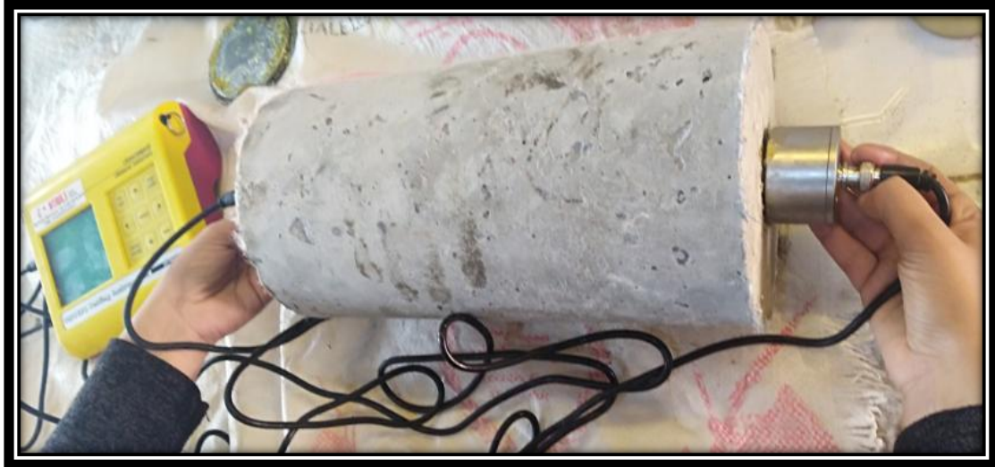
Figure III. 17: mesures à l'ultrason d'éprouvettes cylindrique L=32cm.
