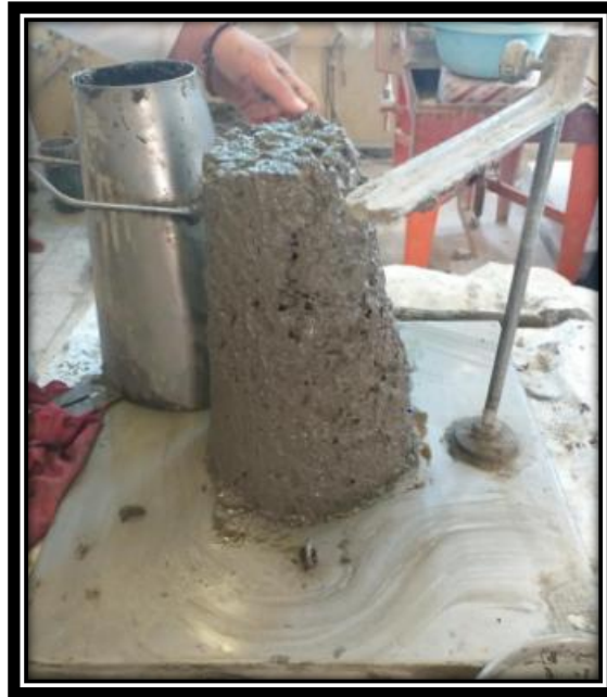
Figure II. 4: L'affaissement de cône d'Abrams d'un béton.
