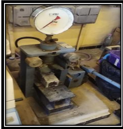
Figure II. 9: Dispositif pour mesurer la résistance à la traction par flexion.
