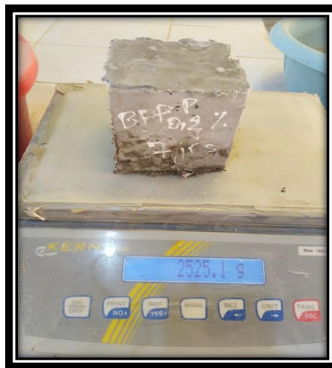
Figure III. 6: peser des échantillons pour trouver le masse volumique du BO et BF (PP).
