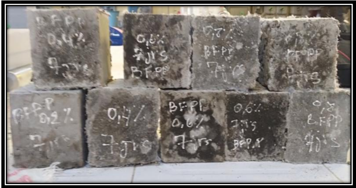
Figure III. 4: quelques échantillons de béton en fibres qui à tenir des essais destructifs et non destructifs
