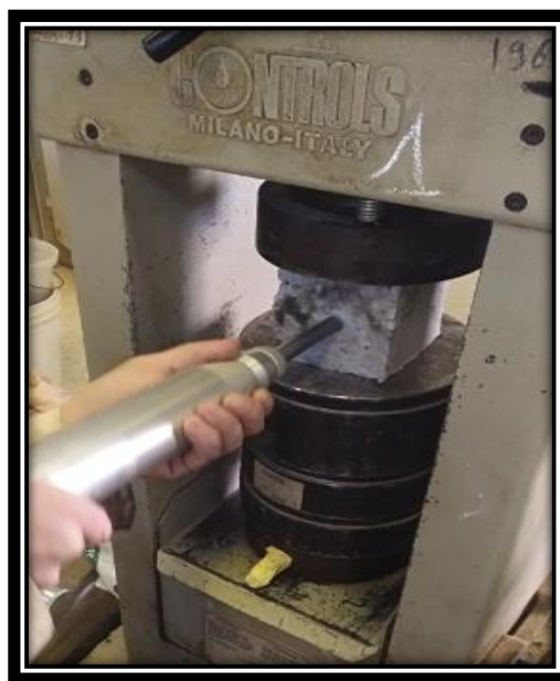
Figure III. 12: mesures à la scléromètre des éprouvettes cubiques
