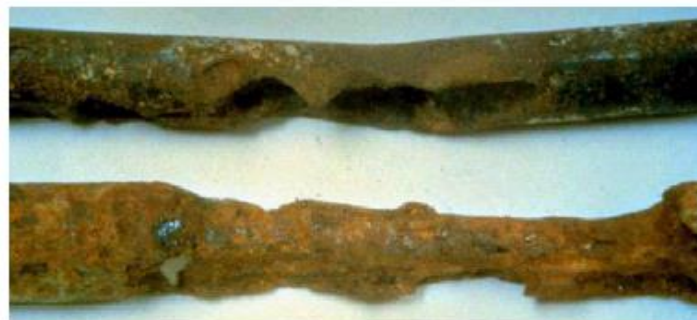
Figure I-18 Piqûre profonde causée par une attaque de chlorure ( http://www.vectorgroup.com/CorrosionOverview.pdf )
