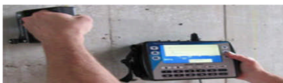
Test Choc-Echo avec appareil Olson's NDE 360 (5)
