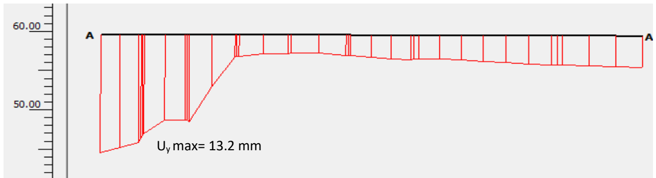
Figure 5.27. Tassement de terrain derrière la paroi de soutènement
