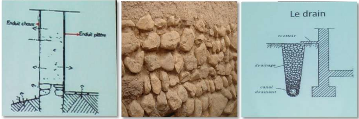
شكل 119 : نظام الصرف الصحي المصدر: محاضرة الأمراض ماستر.2. الصورة 117 : قاعدة من الحجارة القنطرة المصدر: الباحث 2019 شكل 120 : توضيح الجدار بعد تلييسه بالجبس. المصدر: محاضرة الأمراض ماستر.2.
