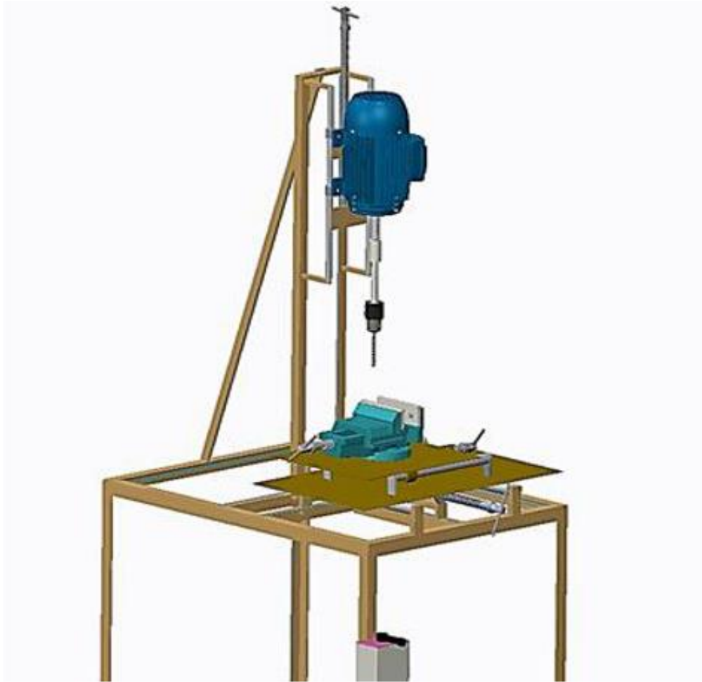
Figure. II. 8: Vue modèle d'une machine de soudage par friction-malaxage modèle de Jithin Ambarayil Joy et all [58].
