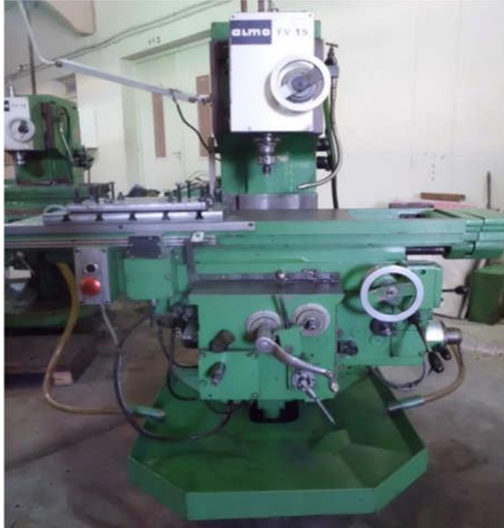
Figure. II. 2: Fraiseuse adaptée pour le FSW, à UCL-PRM [42].
