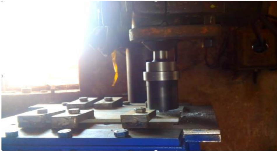
Figure. II. 6: A- Dessin 3D de machine FSW. B- La machine de FSW modèle de Mangesh S. Prabhavalkar et al [56].
