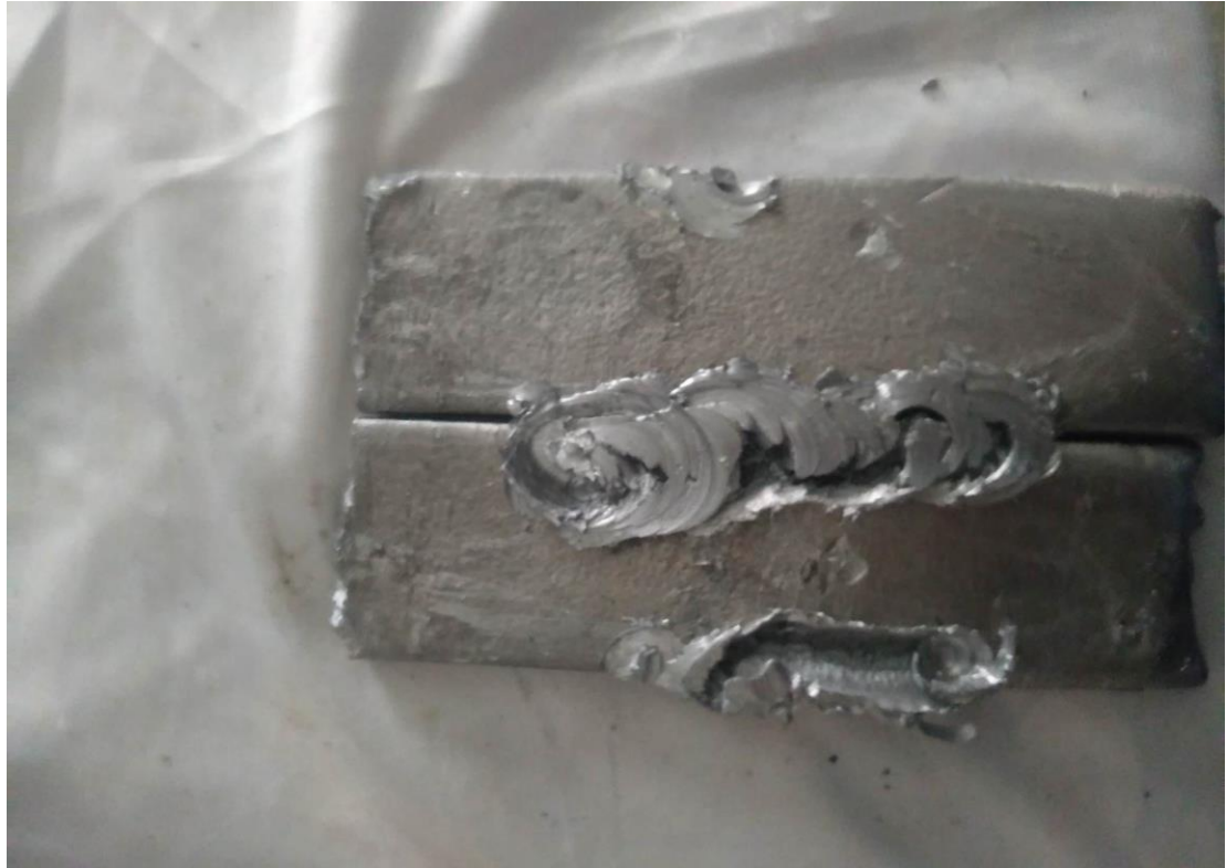
Figure. III. 15: La première expérience de soudage par friction malaxage des toles en plomb..
