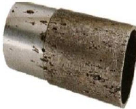
Figure 1-5 : Corrosion par piqûres d'un acier inoxydable
