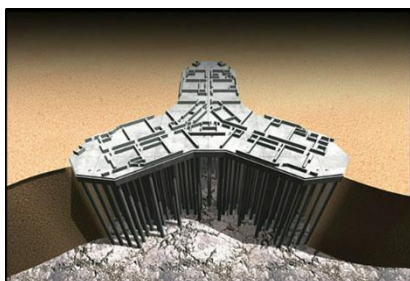
Figure 72 : fondation (Burdj Khalifa) Source : http://tpe--lesgratte-ciels.e monsite.com
