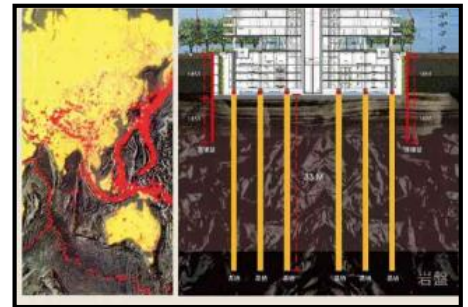
Figure 146: 72 pieux forés dans le substrat rocheux pour l'isolement sismique de classe 7 EPS Source : https://www.skyscrapercity.com
