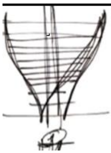
Figure 137 : Le premier objectif est d'être parfaitement intégré dans le profil pyramidal nord / sud du volume du bâtiment. En réalité, la morphologie du projet change en fonction de son orientation. Ses élévations est / ouest dessinent une pyramide rhomboïdale alors que les nord-sud représentent une pyramide inversée. Source : https://www.dezeen
