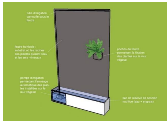
Figure 38: schéma explicatif de la technique de Patrick Blanc Source : http://www.murmurevegetal.com
