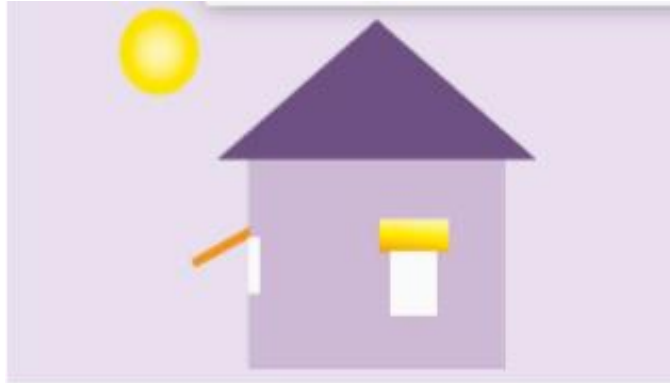
Figure 1.21. Intégration des capteurs solaires en auvent et brise soleil sur les ouvertures.
