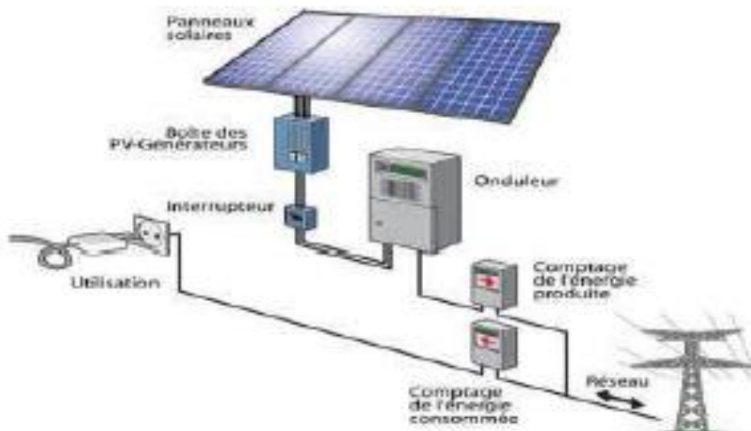
Figure 1.9. Composent de système photovoltaïque.
