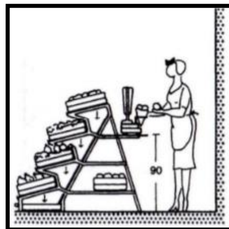
Figure I.41 : Comptoir avec supports pour caisses et paniers.
