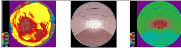
Figure 134 : l'ambiance lumineuse intérieure du modèle équipé de plafond anidolique à 14 h (Daiche S ,2016).
