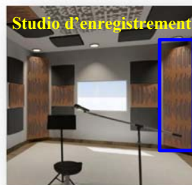
Figure 73 montre emplacement des panneaux acoustique dans le studio et la salle de spectacle de notre projet (source : auteur)
