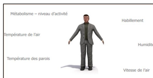
Fig. I. 12 : Paramètres influant sur le confort hygrothermique
