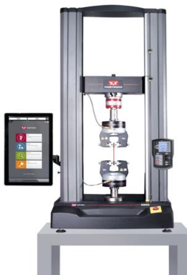
Figure II.8. Machine d'essai statique universel de marque INSTRON 5960 [15].
