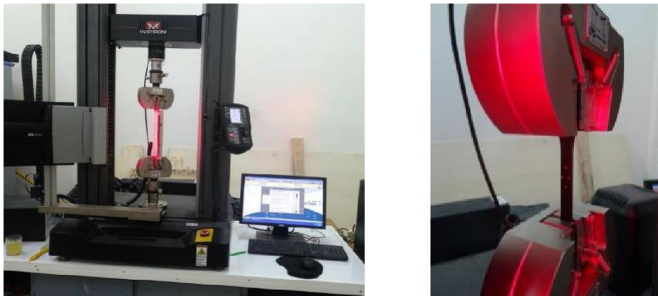
Figure III.3. (a) Machine d'essai de traction, (b) Extensomètre à vidéo Avancé (AVE).
