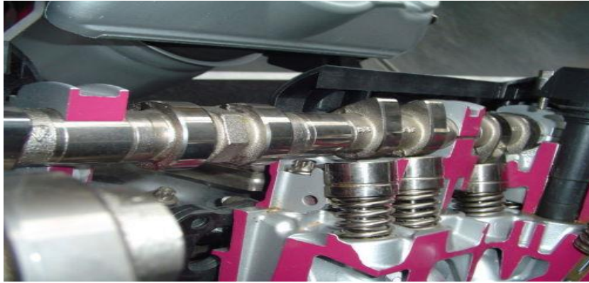
Figure I.9. Arbre à cames dans un moteur à explosion [7].
