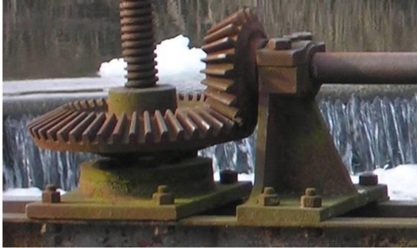
Figure I.11. Engrenage à roues coniques permettant de changer l'axe de rotation [8].
