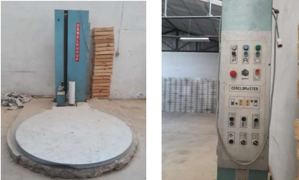
Figure III.6 :Cellophaneuse de boitede date (Machines d'emballage)
