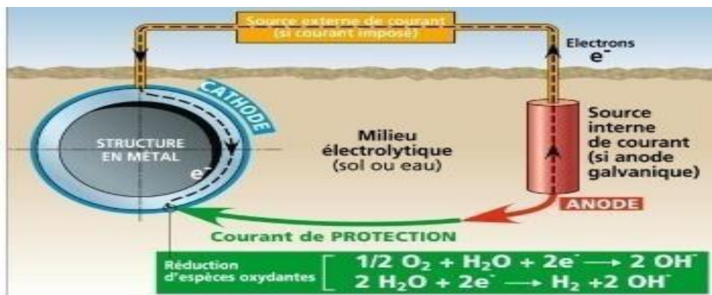
Fig. I.17. Principe de la protection cathodique.
