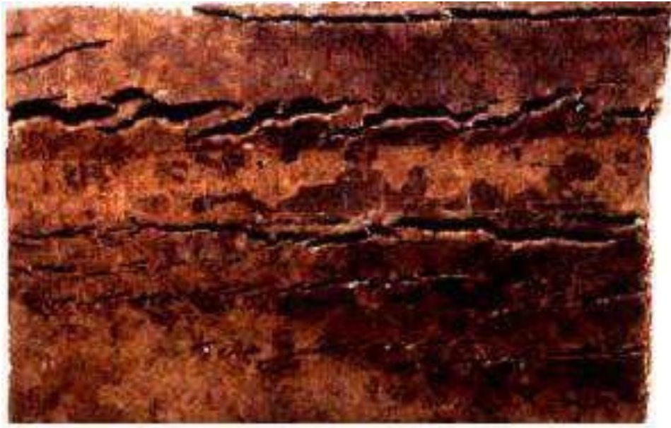
Fig.I.11. Fissures de CSC.
