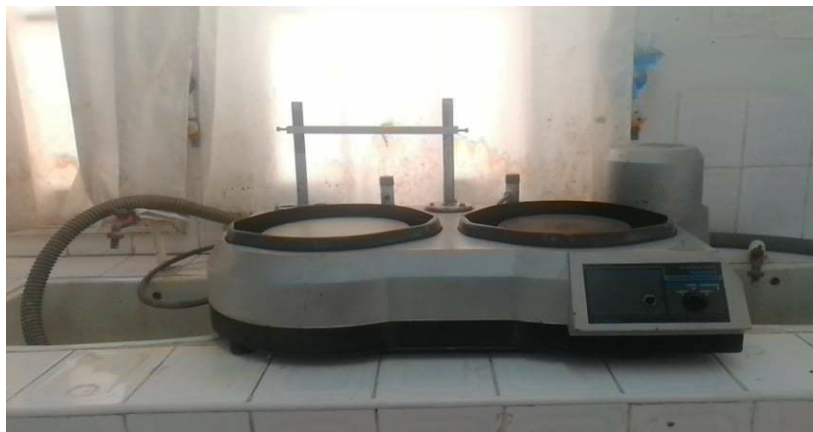
Fig. III.3. Schéma de polisseuse utilise dans le polissage mécanique.
