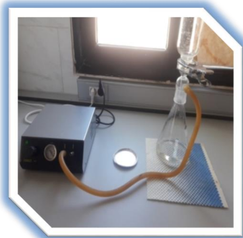
Figure 33 : Filtration sous vide composé d'une pompe et 3 dispositifs de filtration et une fiole de 1 litre.
