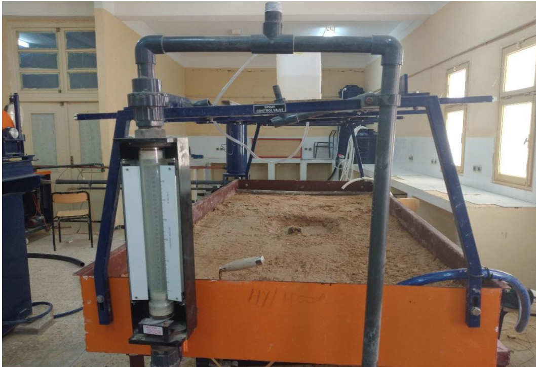
Figure19 : Banc de drainage
