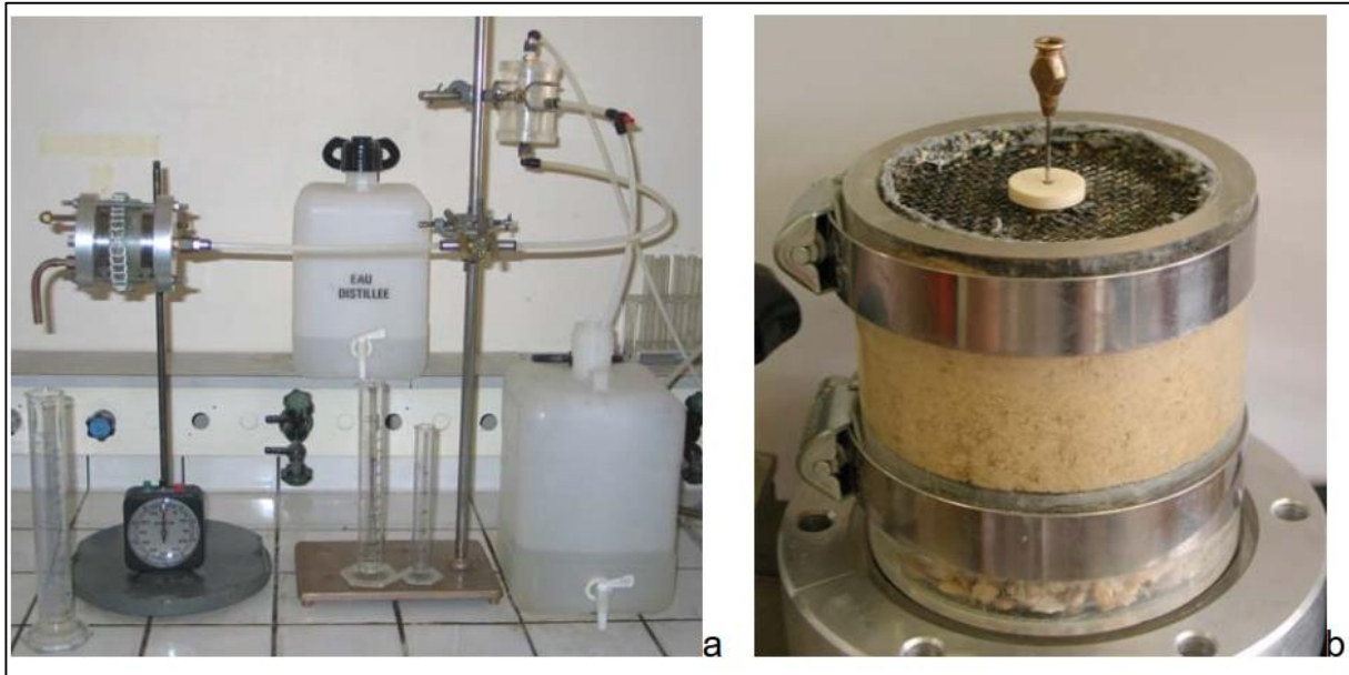
Figure III-28 pinhole test et échantillon durant la réalisation du trou d'aiguille.
