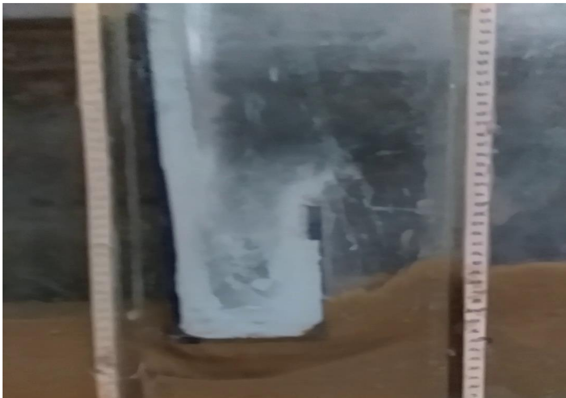
Figure III-17: Rupture de l'ouvrage
