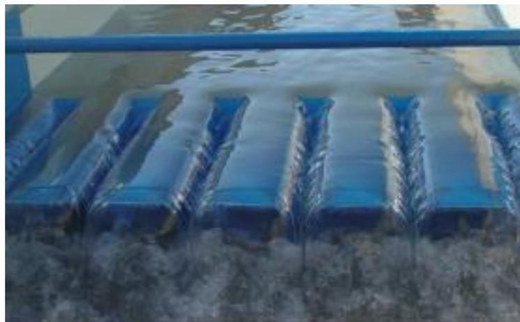
*Figure (I-13) : Photo du plan d'eau à l'entrée du PK-Weir pour un faible débit
