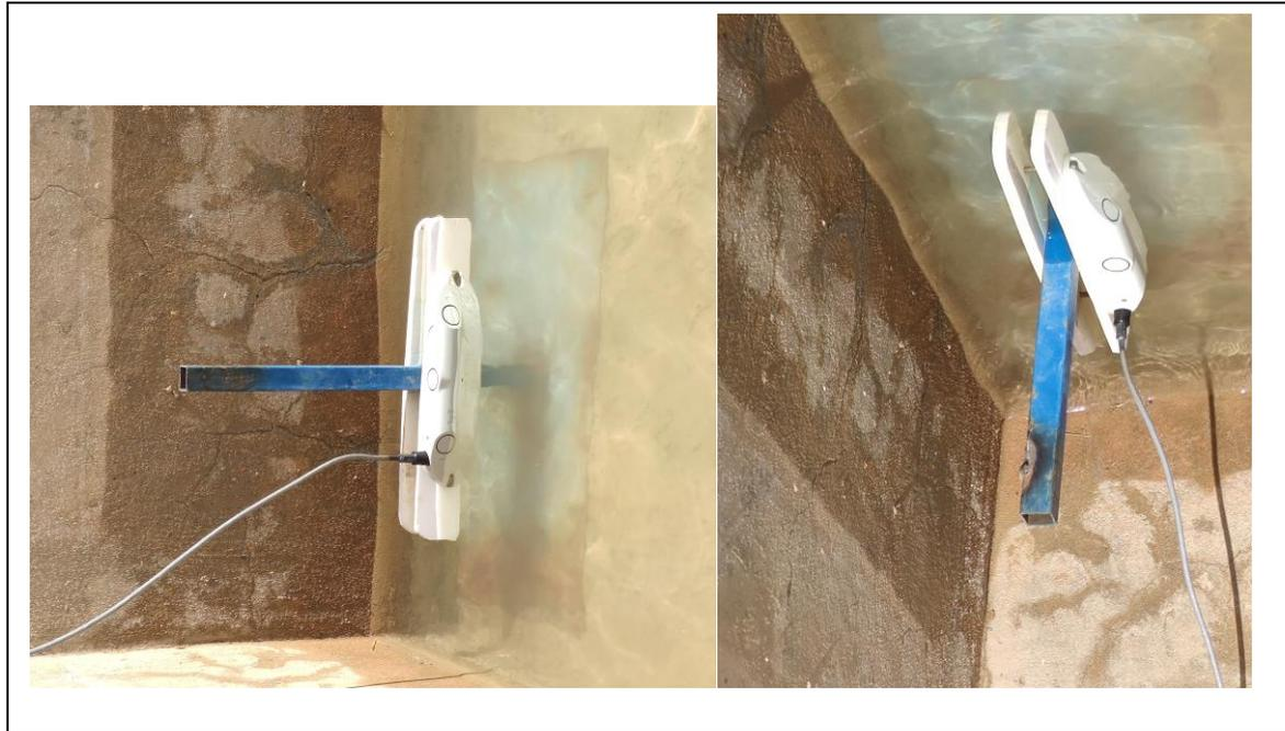
Figure III.10 : Installation du courantomètre dans le canal
