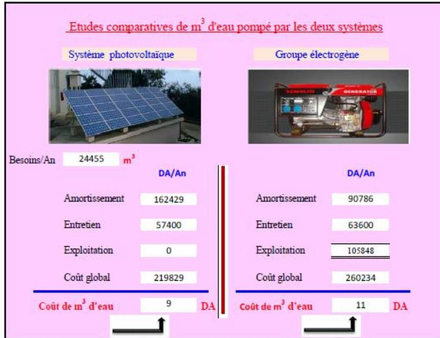
**Figure (I.3) :** Calcul du coût de m<sup>3</sup> d'eau pompée par les deux systèmes (photovoltaïque/électrogène) [1].
