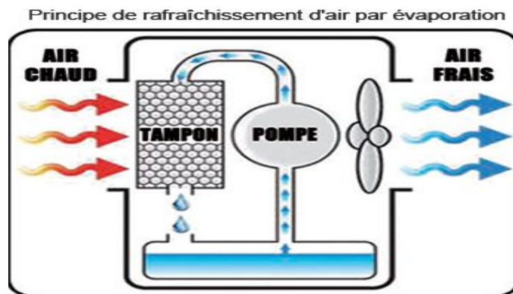
Figure I.7 : Schéma de principe et de fonctionnement d'un humidificateur [14].
