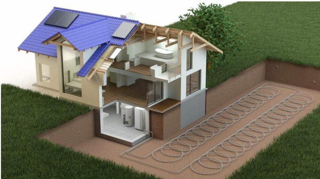
Figure I.4: Exemple d'un échangeur de chaleur enterré [5].
